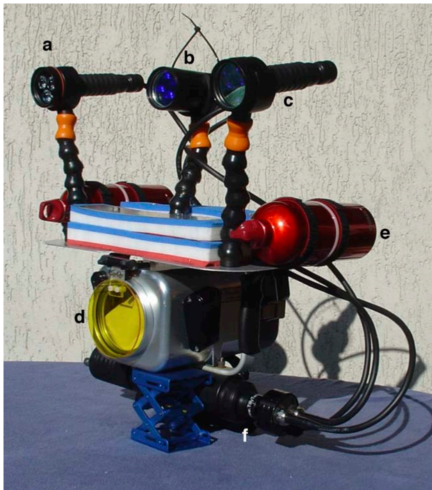
Fig. 12 Sealux® Gehäuse a normale (weiße) LEDs b und c Fluoreszenzleuchten d Sperrfilter e Auf- triebskörper f 2 Akkus (Fa. TillyTec)
