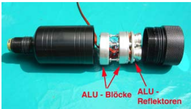
Fluoreszenzleuchte mit OSRAM Hightec LEDs: Links: Explosionsansicht Rechts: Aufsicht auf die OSRAM (OSTAR SMT) LEDs in Multi-Chip-Technologie
