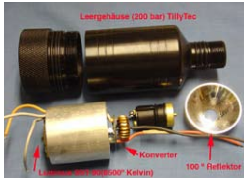
Leuchte mit einer weißen HighTec-LED Links: Aufsicht auf ein LUMINUS SST- 90 (6000 Kelvin, 2250 Lumen) Oben: Explosionsansicht der Leuchte
