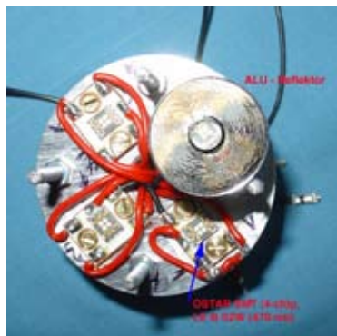
Fluoreszenzleuchte mit OSRAM Hightec LEDs: Links: Explosionsansicht Rechts: Aufsicht auf die OSRAM (OSTAR SMT) LEDs in Multi-Chip-Technologie
