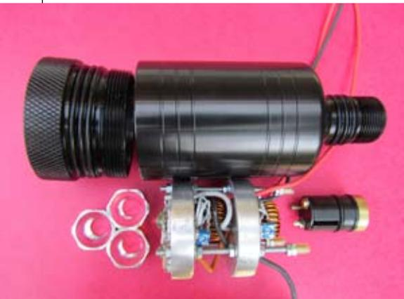
**Fluoreszenzleuchte mit blauen LUMINUS Hightech-LEDs (Neuentwicklung).** In der Explosionsansicht sind zwei Step-Down-Konverter (KSQ) zu sehen, die die drei LEDs mit einem Strom von 6.9 Amp speisen. Die Leuchte wird an einem TT3 Akku (TillyTec, 9 AH, 12 Volt) betrieben.
