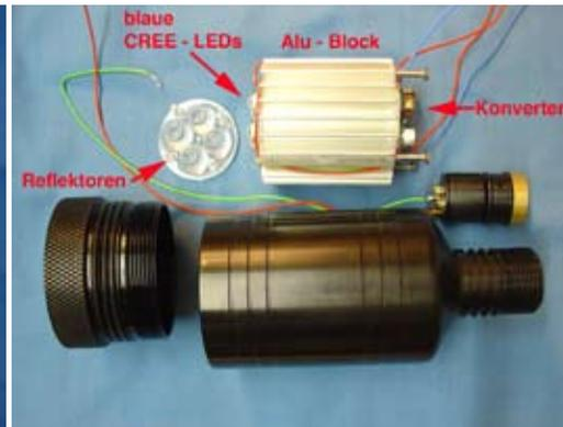
**Aufbau einer Fluoreszenzleuchte mit 4 CREE-LEDs (königsblau, 260 nm) von links nach rechts: Aufsicht auf die vier LEDs, Ansicht von vorne mit vier Reflektoren, Rückansicht – Aufsicht auf zwei Konstantstrom-Ics, Explosionsansicht der Leuchte**
